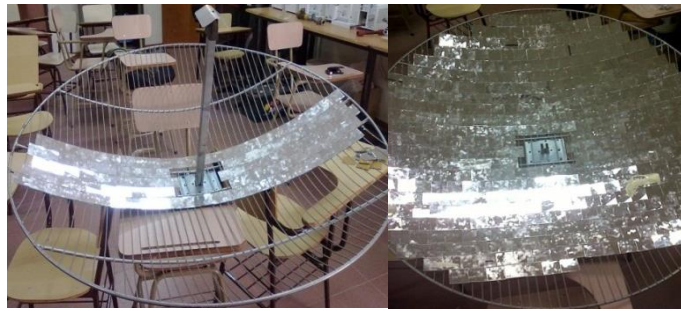
Figura N°4: Vista parcial del pegado de los espejos
