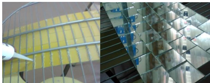
Figura N°3: Vista parcial del pegado de los espejos
